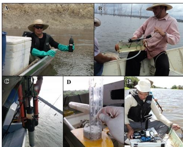
Figura 5 - principais procedimentos da coleta de campo. A e B: coleta manual na superfície da água e em profundidade via garrafa de Van Dorn; C: coletor de sedimento tipo "core" vertical modelo KAJAK; C: separação dos sedimentos em camadas; E: leitura das variáveis limológicas por meio de potenciômetros portáteis
