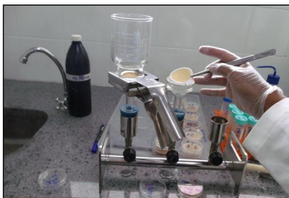
Figura 6 - filtração das amostras de água para coleta de Sedimentos em Suspensão (SS), em destaque filtro contendo SS.
