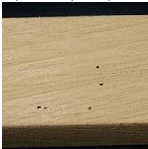
Figura 9 - Orifícios produzidos por brocas.
