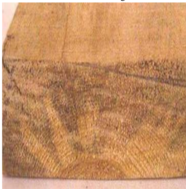
Figura 6 - Características visuais de seção transversal de madeira atacada por fungos manchadores cromogêneos.
