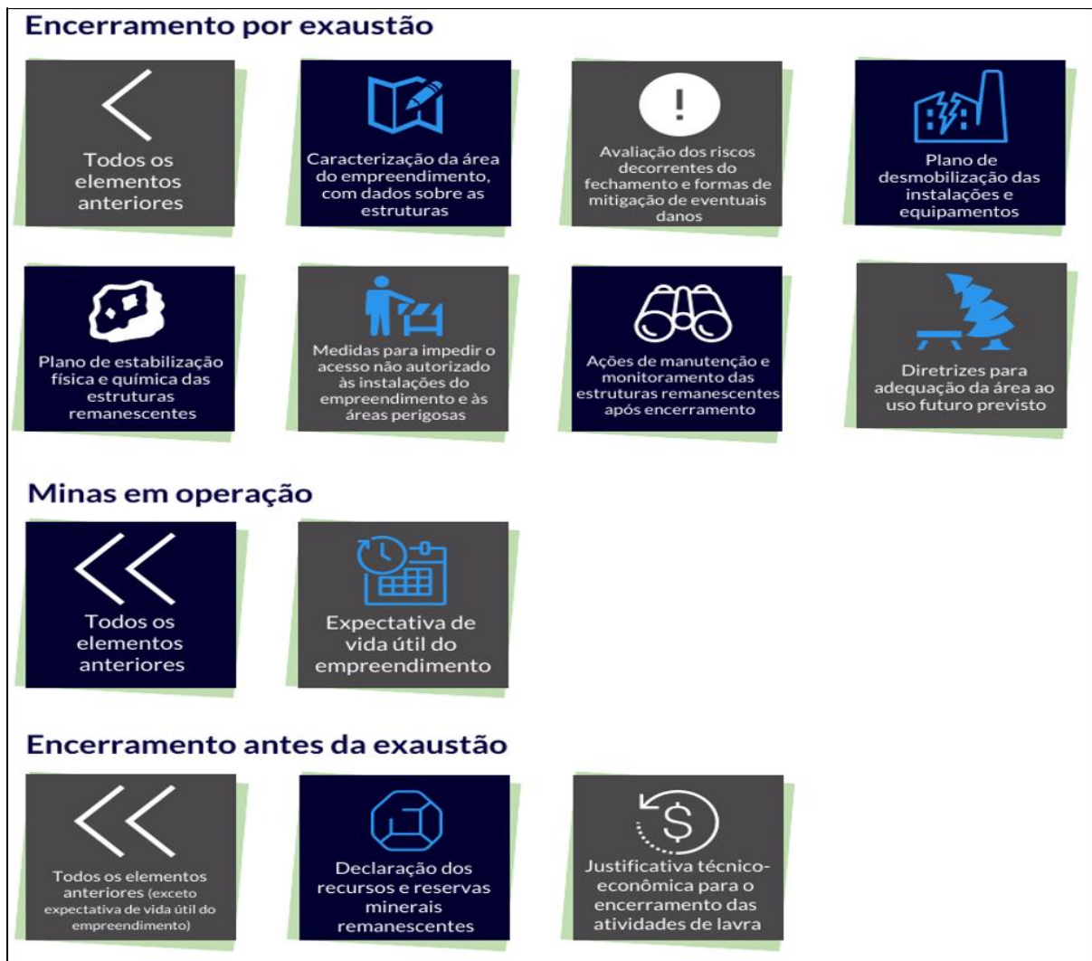
Figura 5 - Elementos do plano de fechamento por exaustão, na operação e antes da exaustão.
