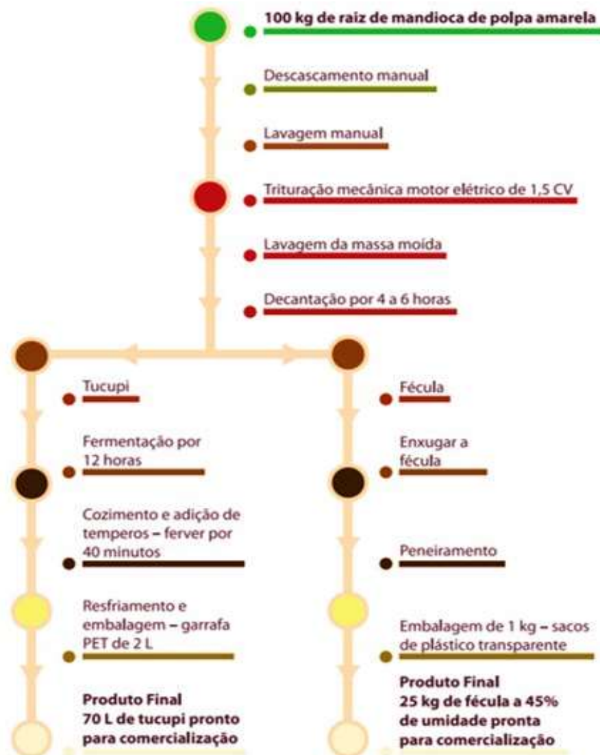
Figura 1: Fluxograma de processamento do tucupi e da fécula a 45% de umidade no Pará.
