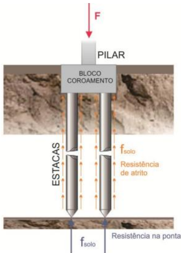
Figura 2: Fundação indireta ou profunda
