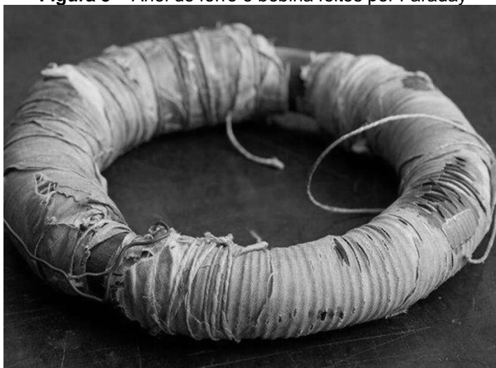
Figura 5 – Anel de ferro e bobina feitos por Faraday
