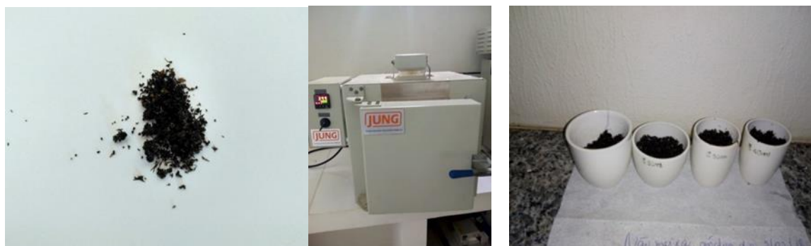
Figura 9- (a) Amostra de esponja após o processo de pré-tratamento, (b) Forno mufla utilizado, e (c) Amostras de esponja prontas para calcinação.
