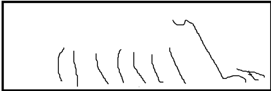
Figura 5 - Viga sem armadura transversal que alcançou a ruína no momento do aparecimento da primeira fissura inclinada.
