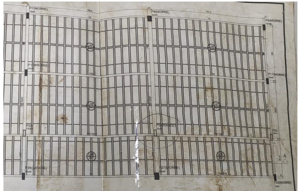
Figura 18 - Planta de forma da cobertura
