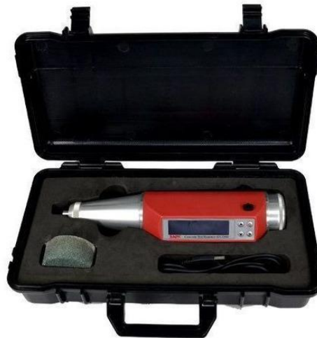
Figura 47 - Esclerômetro utilizado no ensaio de compressão superficial do concreto.
