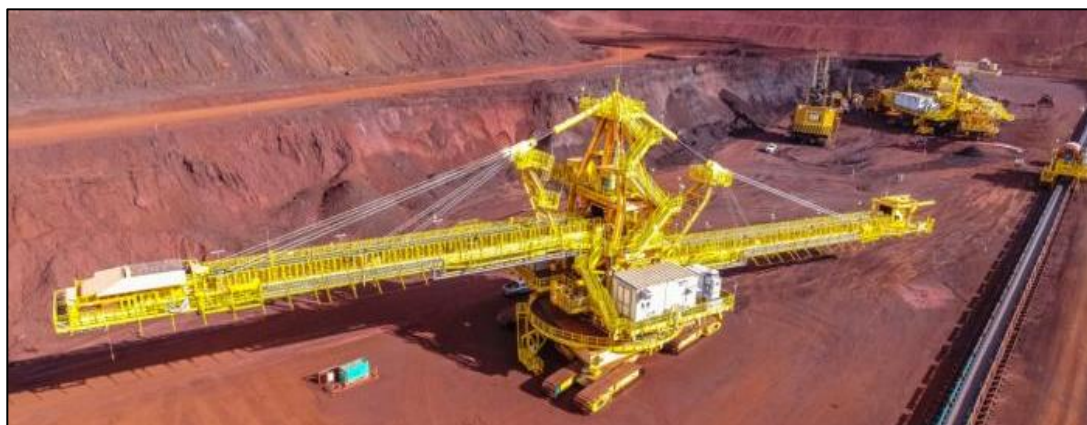
Figura 1 - Lavra em S11D (Vale) com o sistema truckless
