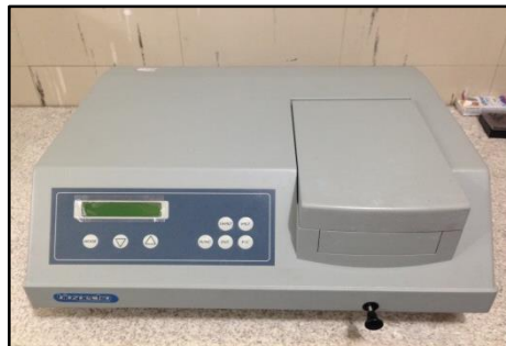
Figura 6 Espectrofotômetro utilizado na análise do Ferro, Nitrito e Amônia. Fonte: Samira Bechara, 2016.
