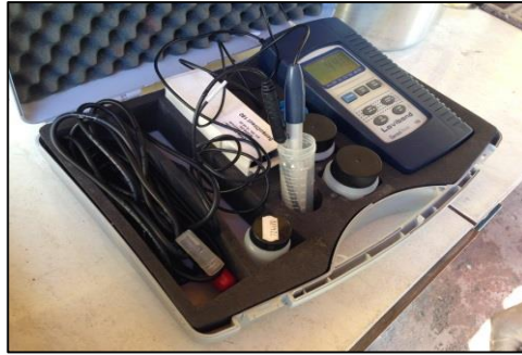
Figura 2 Multiparâmetro utilizado para determinação do pH, condutividade elétrica e TDS. Fonte: Samira Bechara, 2016.
