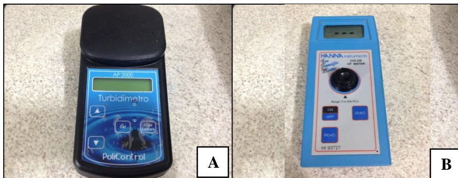
Figura 4 Turbidímetro (A) e Colorímetro (B) utilizados para determinação turbidez e cor, respectivamente. Fonte: Samira Bechara, 2016.
