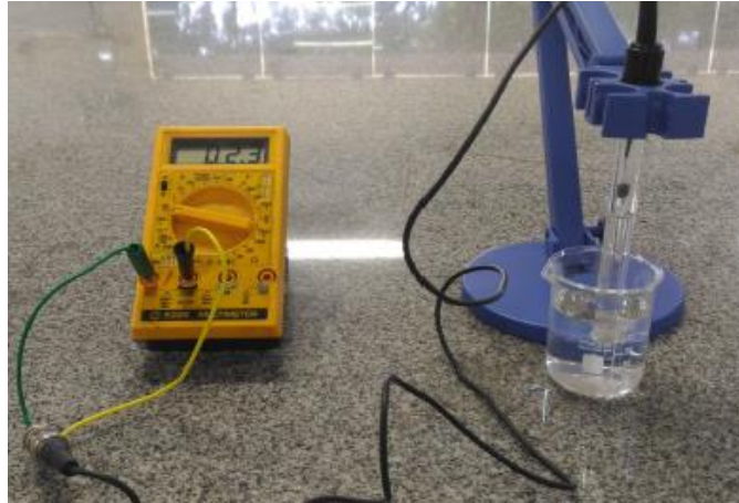
Figura 32 - Multímetro conectado diretamente ao eletrodo para medidas de pH.
