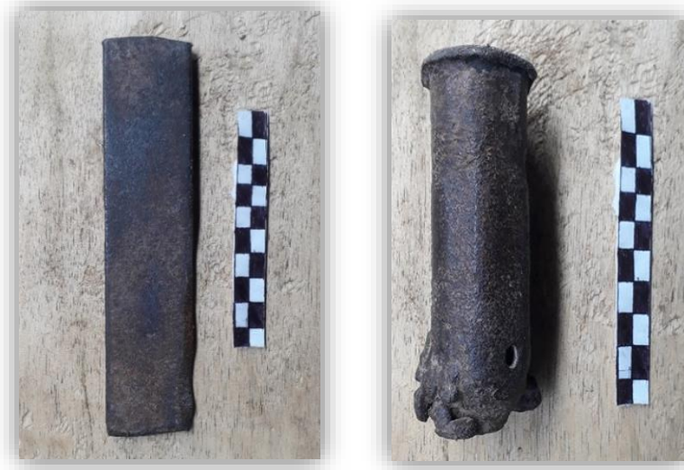
Figura 15 - ferramentas utilizadas para fazer os furos para incrustar os dentes na tabua
