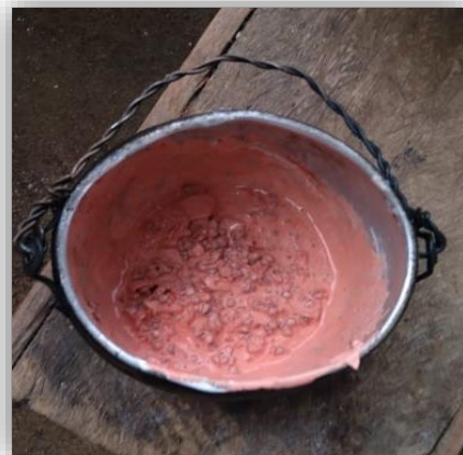
Figura 34 – Resina misturado com urucum
