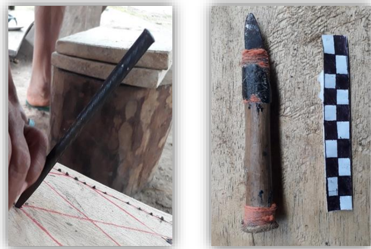
Figura 15 - ferramentas utilizadas para fazer os furos para incrustar os dentes na tabua
