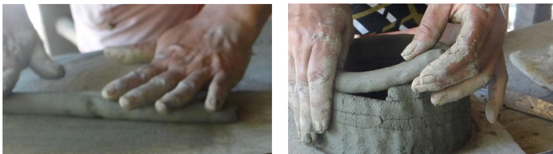
Figura 30. Paneleira produzindo os roletes à esquerda e à direita, levantando a parede de uma panela.
