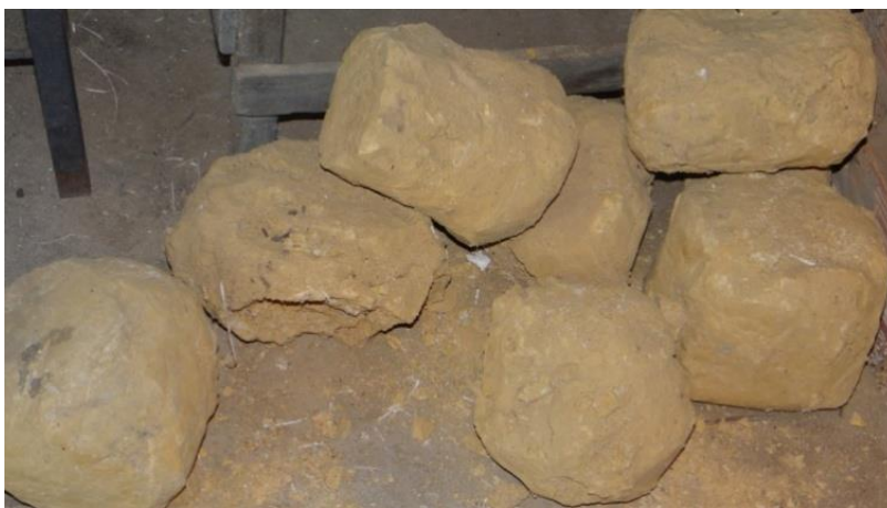
Figura 17. Barro extraído próximo à comunidade do Paissandu, armazenado na forma de bolas no barracão.
