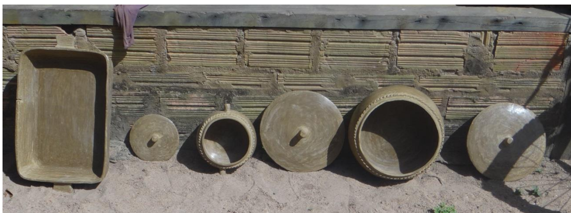
Figura 33. Panelas postas a secagem após a modelação.
