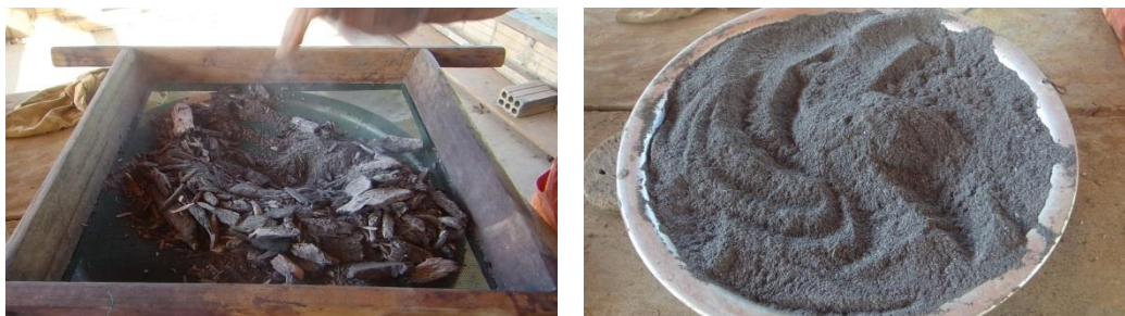
Figura 29. Peneiramento das cinzas de caraipé para obtenção do tempero que compõe a pasta.
