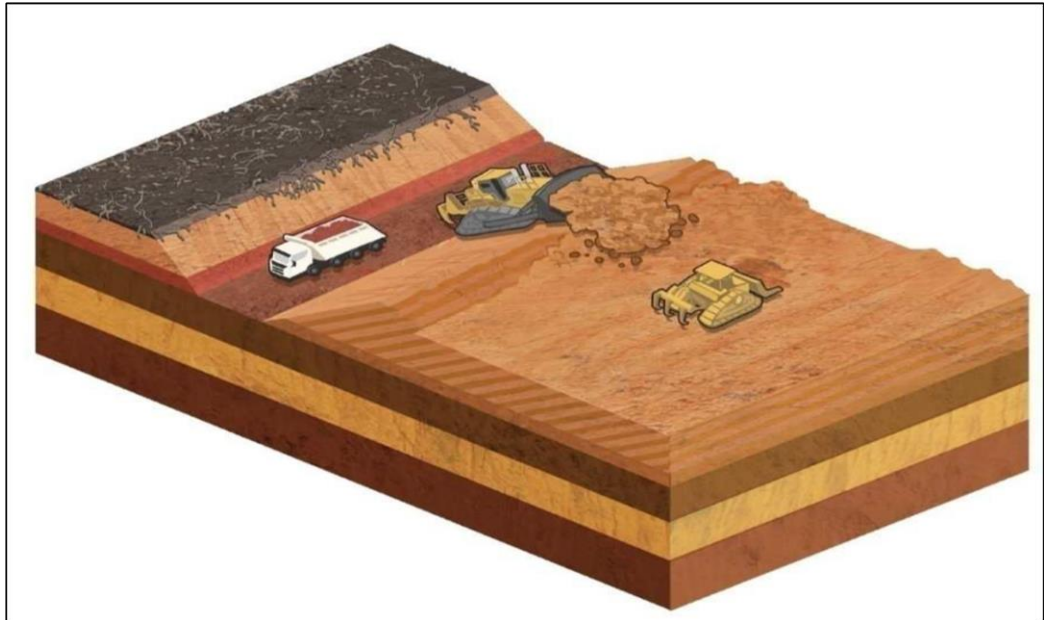
Figura 13 - Figura esquemática da recomposição e reconformação topográfica.
