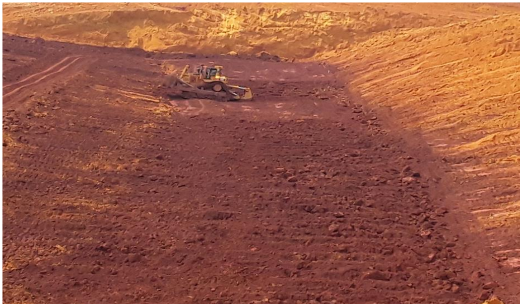
Figura 10 - Desmonte mecânico do minério com trator de esteiras D11.
