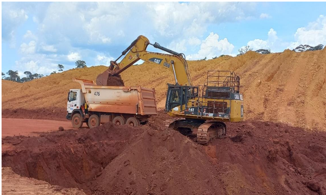
Figura 12 - Lavra e transporte do minério (Frente com menos geração de blocos).
