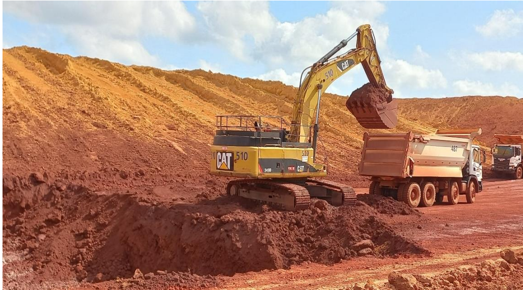
Figura 11 - Lavra e transporte do minério (Frente com mais geração de blocos).
