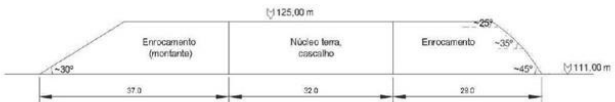
Figura 1 - Seção transversal da barragem Saad El Kafara
