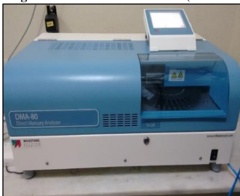
Figura 21 - Analisador DMA 80 (Milestone)
