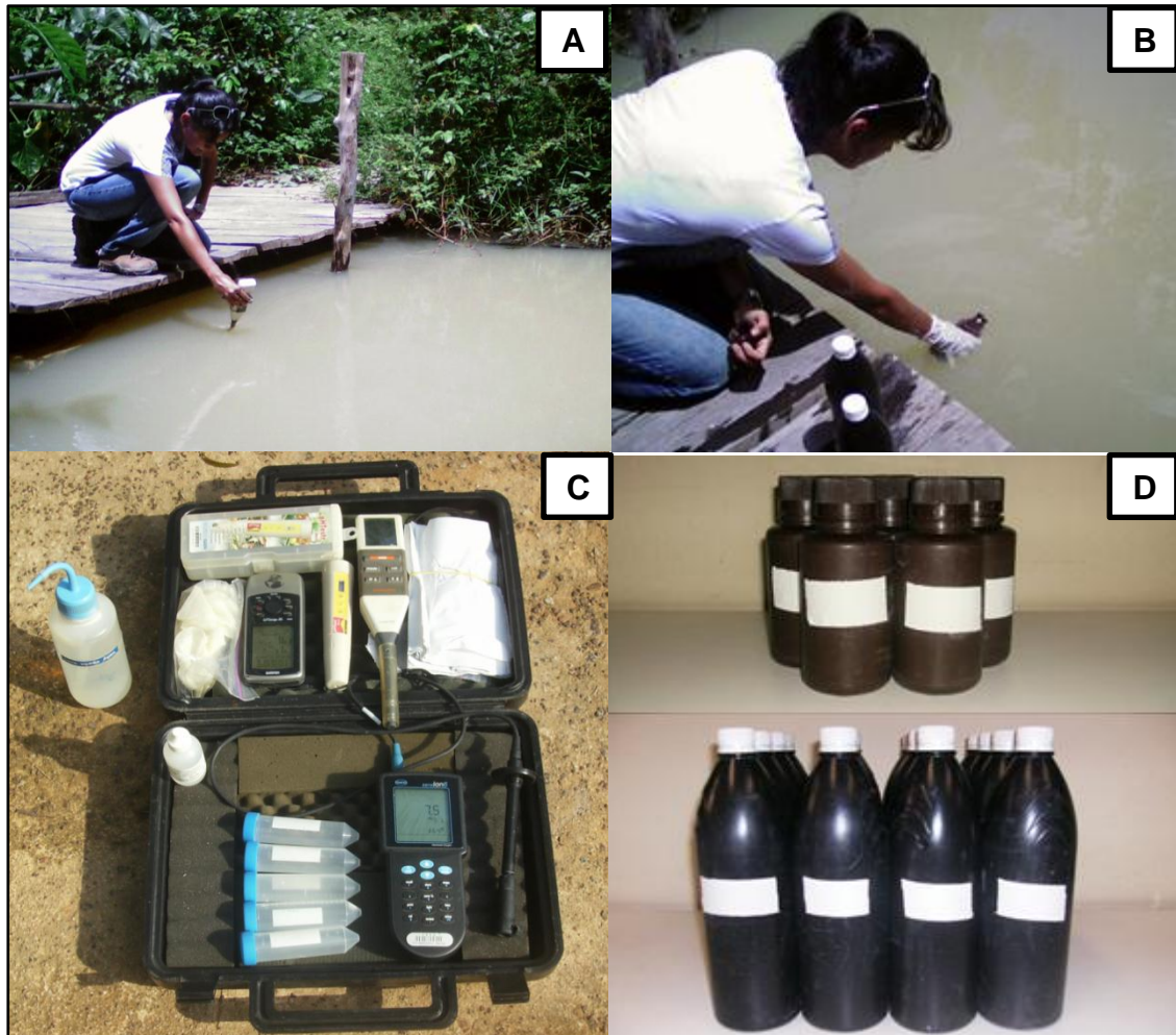
Figura 6 – Fotos da coleta e análise de águas superficiais em campo: A) Análise de parâmetro; B) Procedimentos de coleta de água; C) Equipamentos portáteis utilizados para análise e georreferenciamento; D) Garrafas de polipropileno utilizadas para coleta da amostra.
