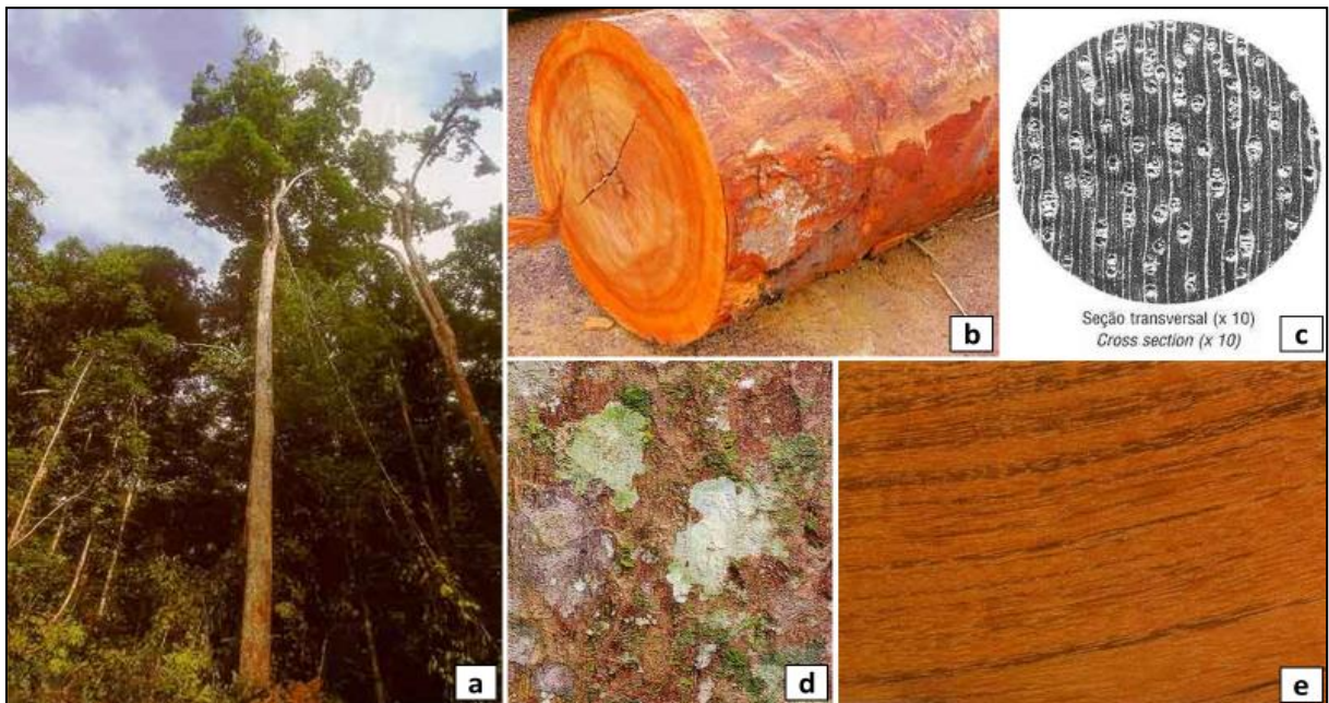
Figura 4 - Muiracatiara: (a) árvore, (b) tora, (c) seção transversal, (d) casca, (e) corte tangencial.
