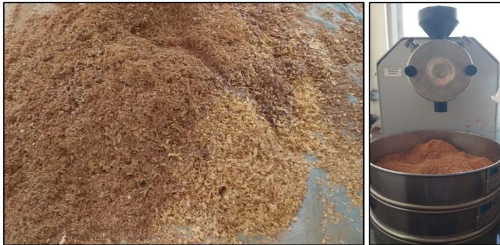
Figura 21 - Maravalha colida após processamento da madeira a esquerda e após moagem em moinho de facas.
