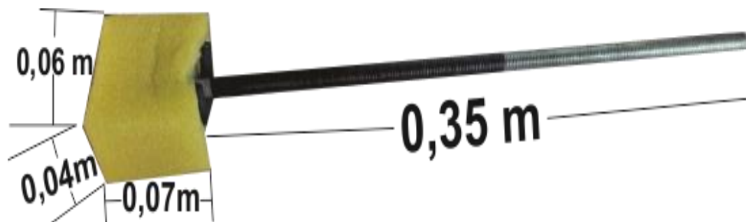
Figura 07: Pistão de lançamento do projétil.
