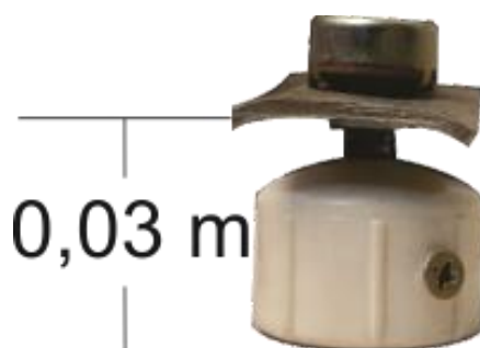
Figura 05: Suporte do potenciômetro visto de lado dimensionado
