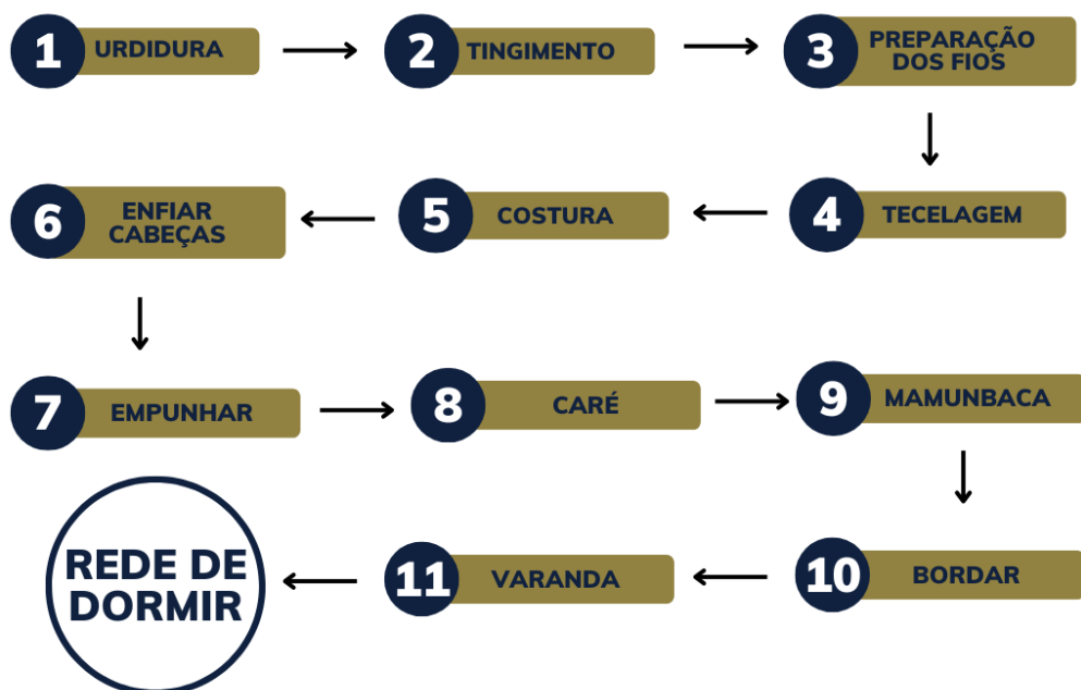
Fluxograma 01 – Etapas do processo de fabricação da rede de dormir.
