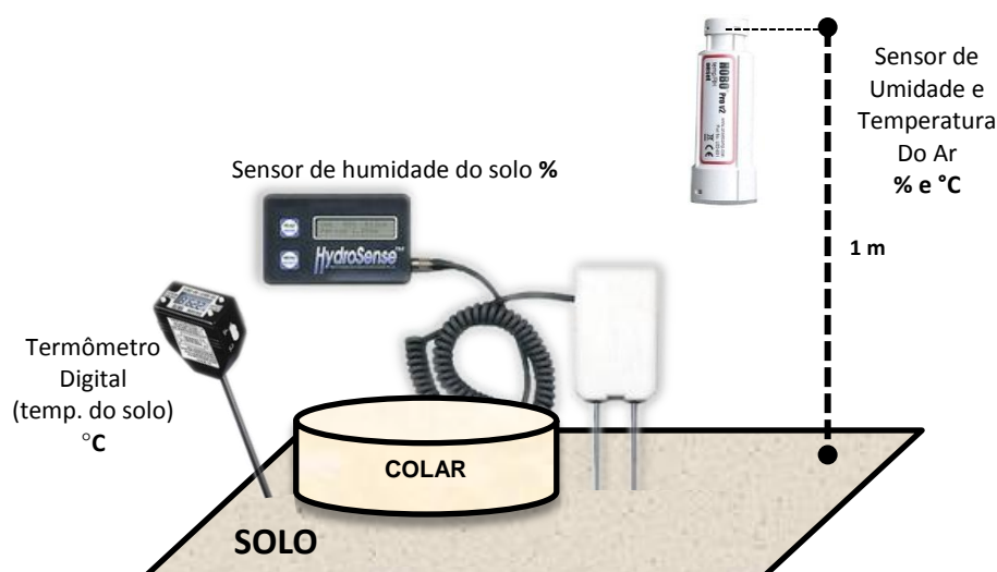
Figura 8 – Esquema de aquisição das variáveis: umidade do solo e do ar, temperatura ambiente e do solo.
