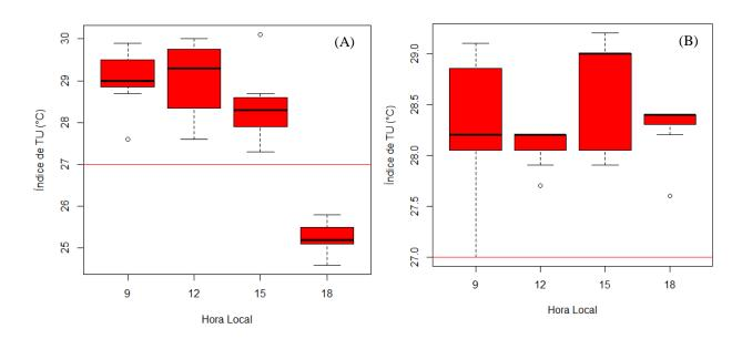
Figura 9 – Variação do Índice de temperatura e umidade entre os pontos e por hora com termohigrômetro automático (9A) e com o psicrômetro (9B) no dia 15 de agosto de 2018 ambiente externo do Residencial Salvação no município de Santarém-PA.
