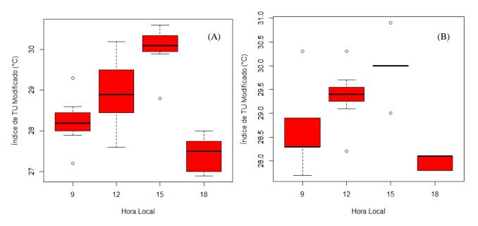
Figura 12- Variação do Índice de temperatura e umidade modificado entre os pontos e por hora com termohigrômetro automático (12 A) e com o psicrômetro (12 B) no dia 15 de agosto de 2018 ambiente interno do Residencial Salvação no município de Santarém-PA.
