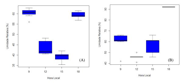
Figura 5- Variabilidade horária da Umidade Relativa com uso do termohigrômetro automático (6A) e do psicrômetro (6B) registrada no dia 15 de agosto de 2018 para o ambiente externo na área do Residencial Salvação no município de Santarém-PA.
