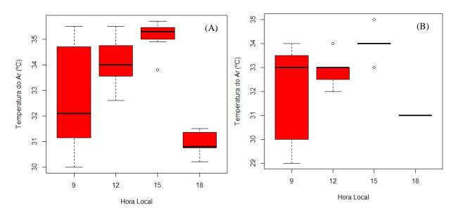
Figura 4 - Variabilidade horária da temperatura do ar com uso do termohigrômetro automático (4A) e o psicrômetro (4B) registrada no dia 15 de agosto de 2018 para o ambiente interno na área do Residencial Salvação no município de Santarém-PA.
