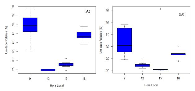
Figura 6 – Variabilidade horária da Umidade Relativa com uso do termohigrômetro automático (6A) e do psicrômetro (6B) registrada no dia 15 de agosto de 2018 para o ambiente interno na área do Residencial Salvação no município de Santarém-PA.
