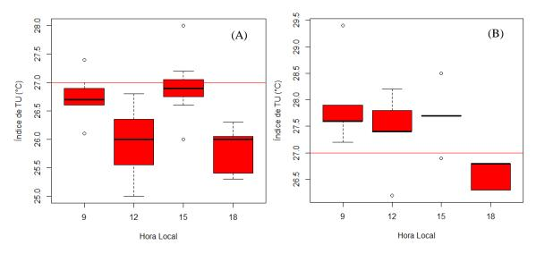
Figura 10- Variação do Índice de temperatura e umidade entre os pontos e por hora com termohigrômetro automático (10 A) e com o psicrômetro (10 B) no dia 15 de agosto de 2018 ambiente interno do Residencial Salvação no município de Santarém-PA.
