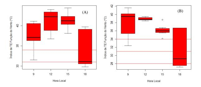
Figura 13- Variação do Índice de temperatura em função do vento entre os pontos e por hora com termohigrômetro automático (13 A) e com o psicrômetro (13 B) no dia 15 de agosto de 2018 ambiente externo do Residencial Salvação no município de Santarém-PA.
