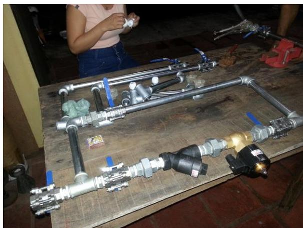
**Figura 8:** Montagem dos arranjos hidráulicos.
