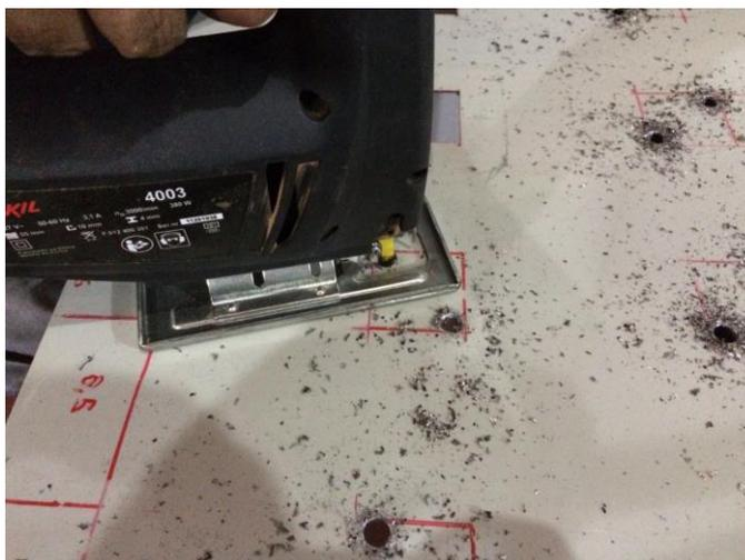
**Figura 11:** Processo de corte e perfuração da caixa de comando.
