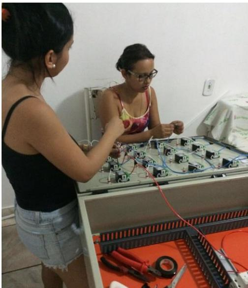
**Figura 13:** Processo de montagem da fiação da caixa de comando.
