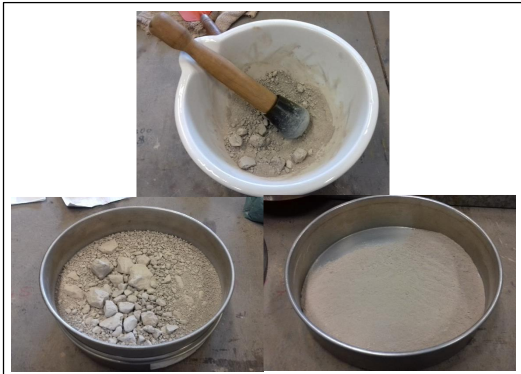
Figura 13 – Destorroamento e peneiramento da argila
