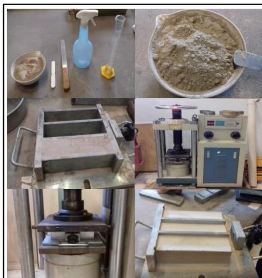
Figura 16 – Processo de mistura/homogeneização, conformação e desforma dos CPs
