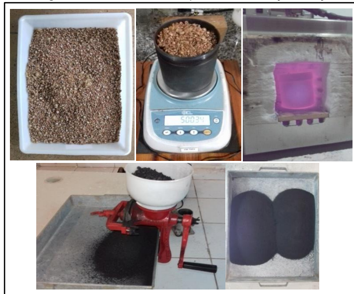
Figura 11 – Processo de queima do caroço de açaí
