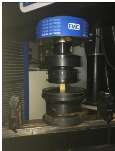
Figura 14: Corpo de prova ajustado na máquina (ensaio de compressão perpendicular).
