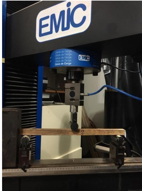
Figura 15: Corpo de prova ajustado na máquina no ensaio (Flexão estática).
