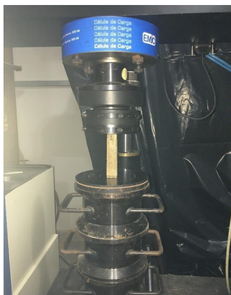
Figura 13: Corpo de prova ajustado na máquina no (ensaio de compressão paralela).
