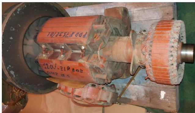
figura 34 - Rotor de 4 pólos com seu ventoinha e excitatriz, rotor da excitatriz acoplado, estator da excitatriz (ao lado)
