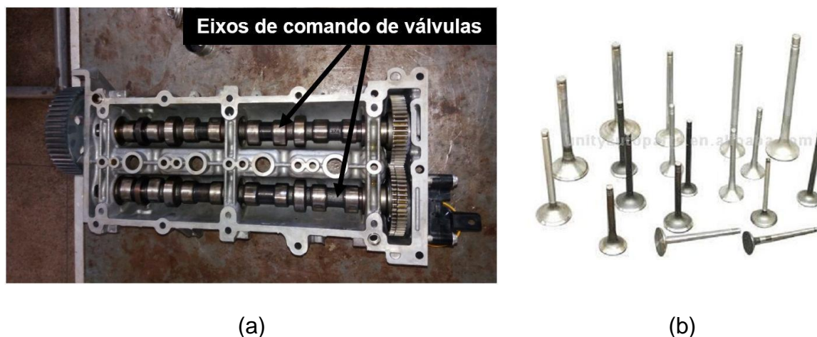
figura 9 - (a) Eixos de camos de comando de válvulas; (b) Válvulas
