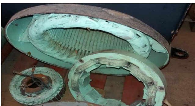
figura 33 - Estator de um gerador com seu respectivo conjunto de excitatriz
