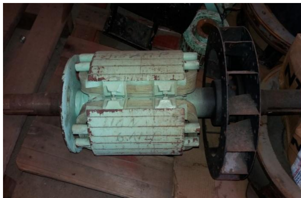
figura 26 - Rotor de 4 pólos de um gerador e ventoinha
