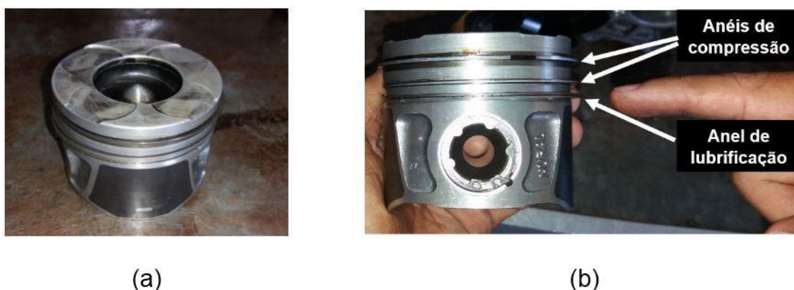
figura 4 - (a) Exemplo de um pistão; (b) Anéis de segmento do pistão
