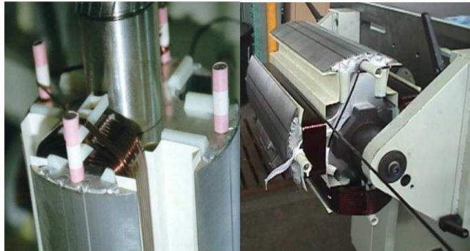
figura 31 - Enrolamento dos pólos de um rotor
