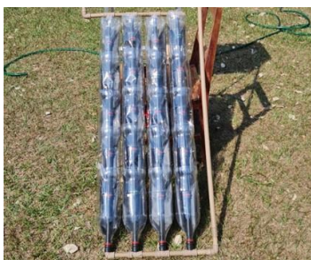
Figura 5 - Estrutura do coletor solar utilizado no ensaio de desinfecção da água.
