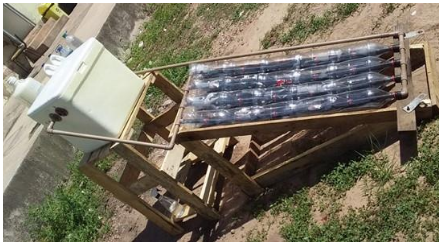
Figura 7 - Estrutura do reservatório com água, ligada ao coletor solar durante o processo de desinfecção pela exposição da luz solar.
