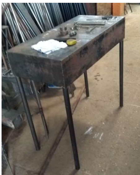
Figura 21 – Montagem dos tubos de sustentação e chapa de aço superior da bancada.
