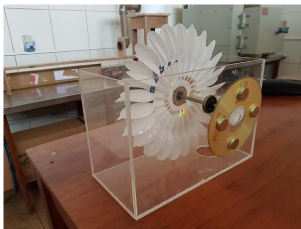
Figura 01: Experimento da mini-hidrelétrica.
