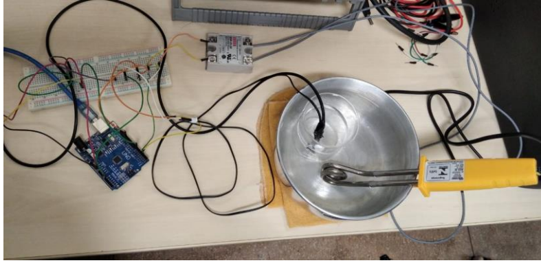
Figura 1: Coletada de dados para a calibração do NTC.
