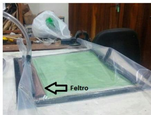
Figura 2. Configuração do processo de fabricação, com utilização de retardante de fluxo (Feltro).
