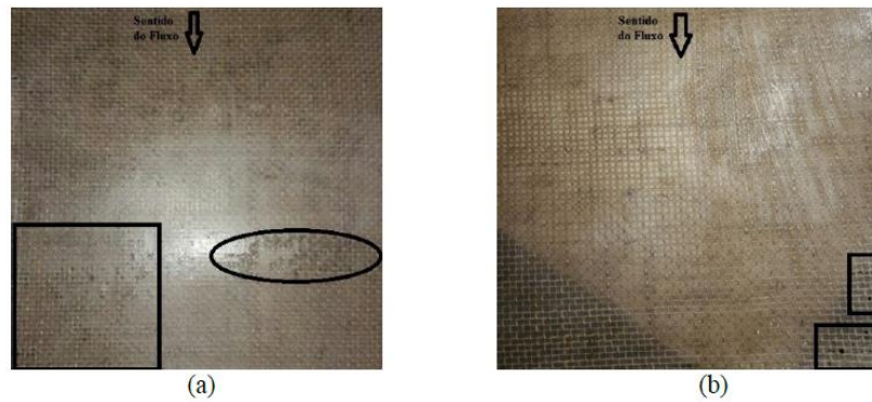
Figura 4. Homogeneidade da matriz poliéster (a) Compósito sem retardante e (b) Compósito com retardante.
