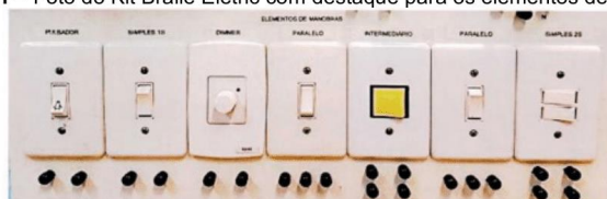
Figura 21 – Foto do Kit Braile Eletric com destaque para os elementos de manobra
