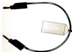
Figura 25 – Foto do Kit Braile Eletric com destaque para o elemento condutor com etiqueta de identificação em Braille
