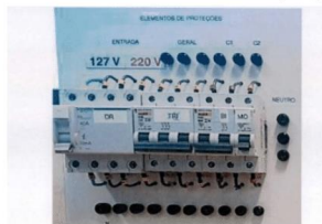
Figura 19 – Foto de Kit Braile Eletric com destaque para os elementos de proteções
