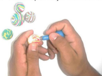
Figura 43 - Aberturas para fixação das hastes flexível, feitas com punção
