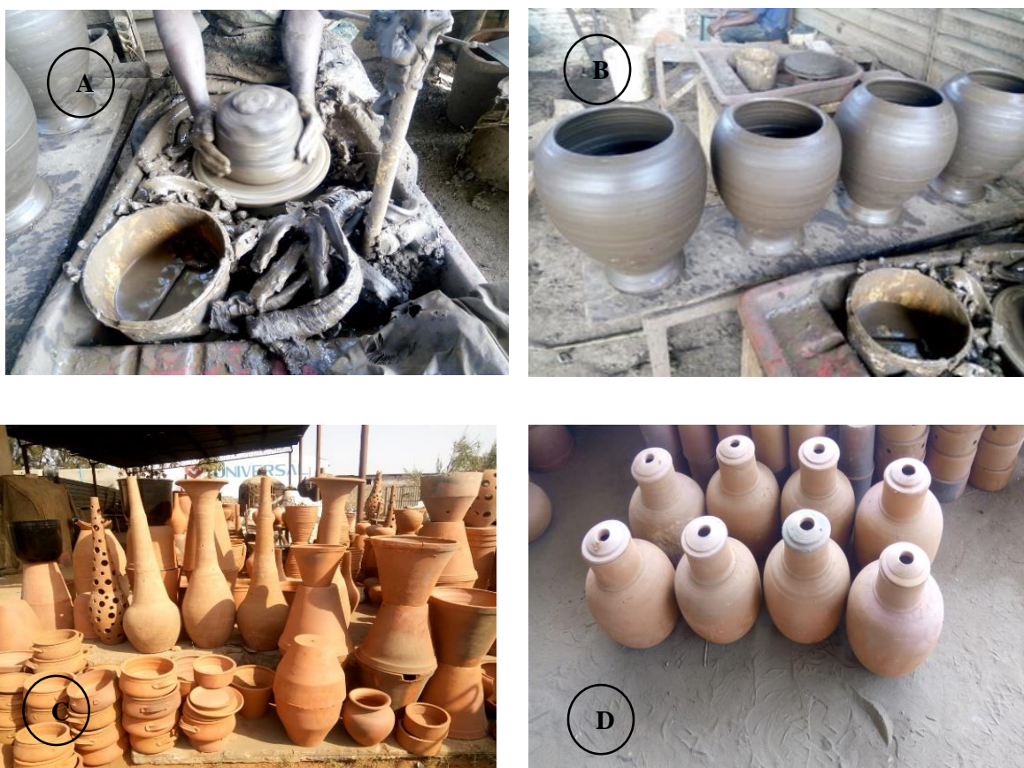
Figura 9 Processo de produção dos potes usados no experimento. A- Seleção da argila e moldagem dos potes, B- dimensionamento dos potes usados no ensaio, C- Processo de secagem dos potes, D- Potes prontos a serem usados no ensaio
