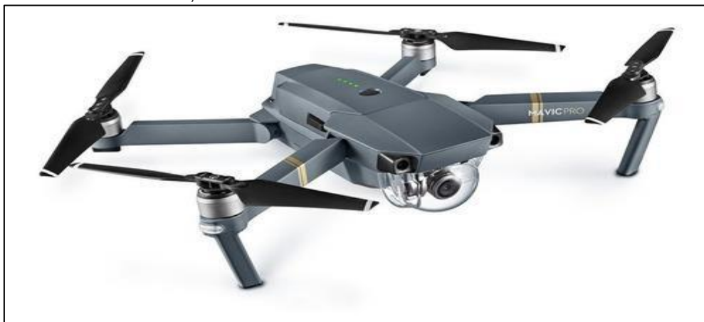
Figura 3- VANT DJI Mavic Pro, utilizado no aerolevamento.
