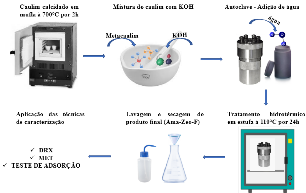
Figura 11. Representação esquemática da rota de síntese empregada neste trabalho.
