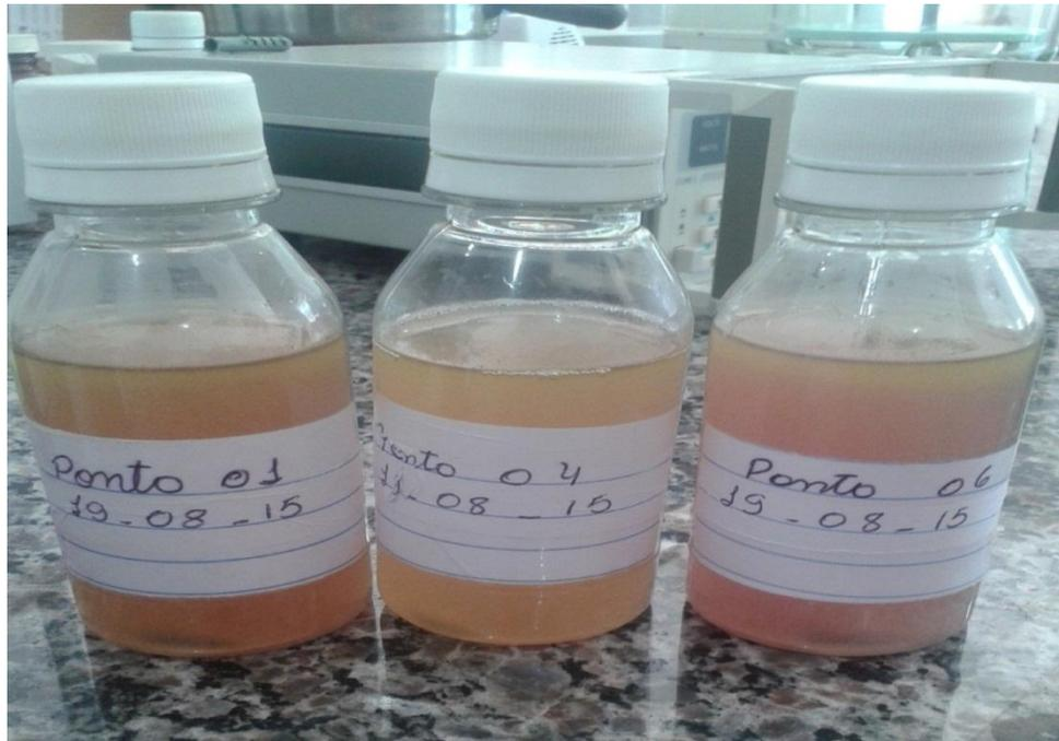
**Figura 9:** amostras com alteração (positivo) para coliformes totais.
