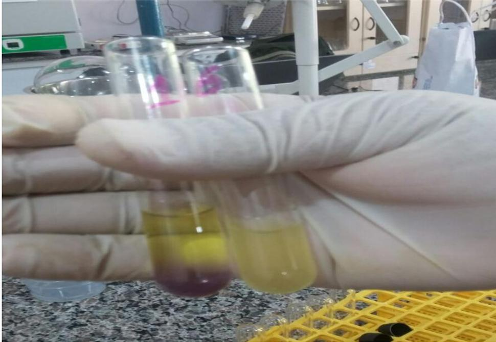
**Figura 10:** amostras com alteração (positivo) para coliformes termotolerantes.
