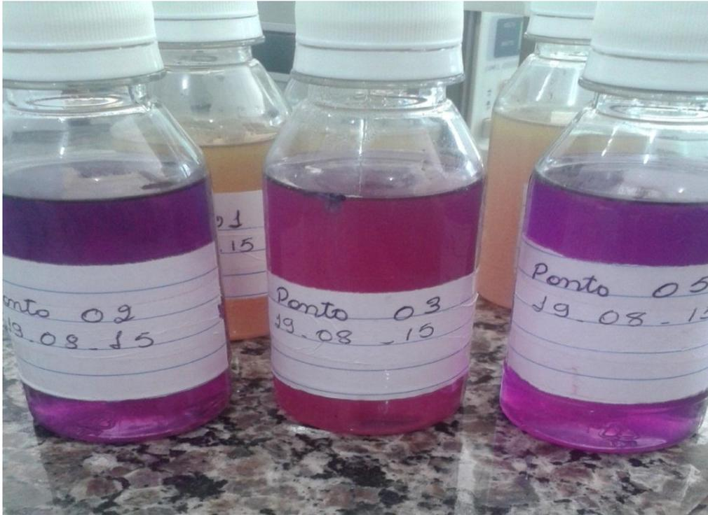
**Figura 8:** amostras sem alteração (negativo) para coliformes totais.
