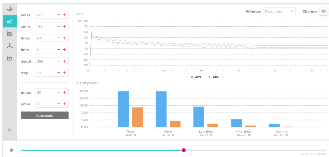
Figura 37 – Registro das ondas capturadas pelos eletrodos AF3 e AF4
