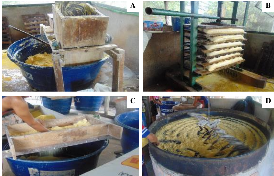
Figura 8: (A)- trituração da mandioca; (B) – prensagem; (C) -peneiramento; (D)- torrefação, nas casas de farinha.
