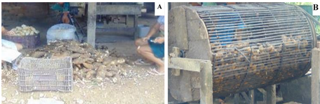
Figura 7: (A)- descascamento manual da mandioca; (B)- Lavador-descascador rotativo de raízes.
