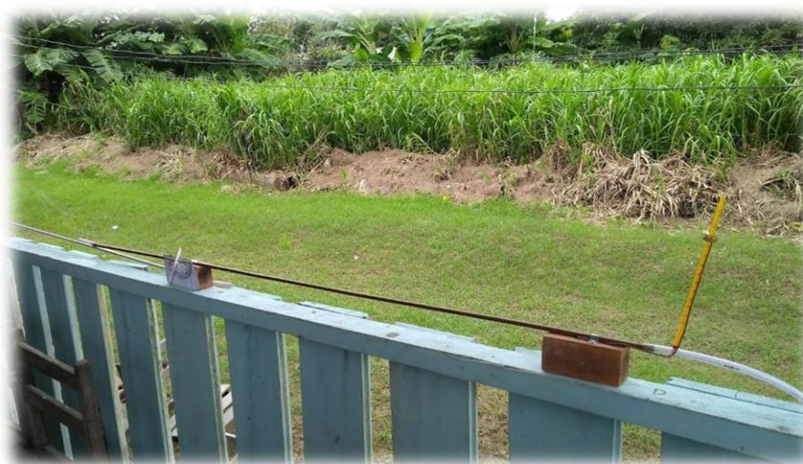
**Figura 3.14.** Dilatômetro aplicado no SOME. Fonte: Os autores.
