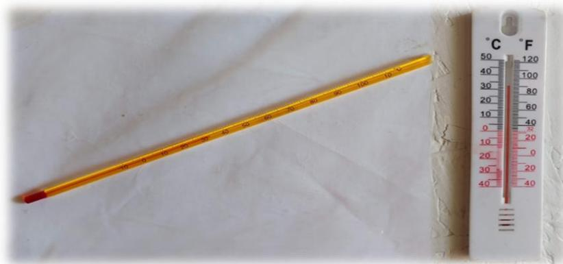
**Figura 3.2.** Termômetros analógicos. Fonte: Os autores.
