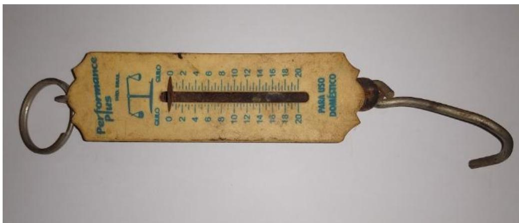
**Figura 4.2.** Balança de mola ou dinamômetro. Fonte: Os autores
