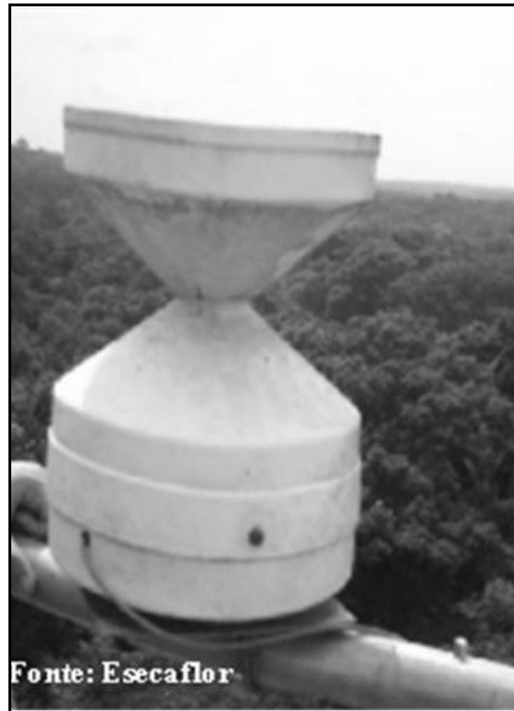
Figura 15 - Pluviográfico instalado no topo da torre.
