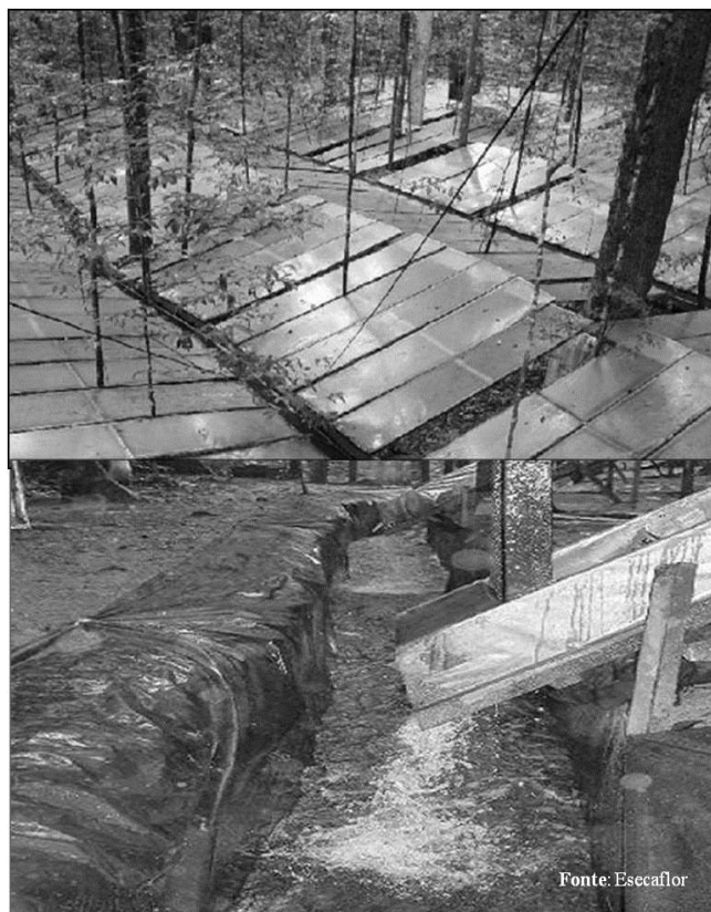
Figura 2 – Painéis coletores de água, calhas de drenagem e trincheira.
