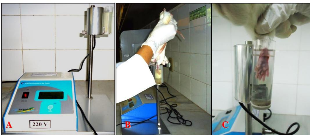
Figura 3: Teste de edema de pata induzido por carragenina. A: Pletismômetro digital Insight®; B: Imobilização do animal e inserção da pata no aparelho; C: Detalhe da inserção pata na coluna de líquido (solução de detergente líquido a 1%) do pletismômetro.
