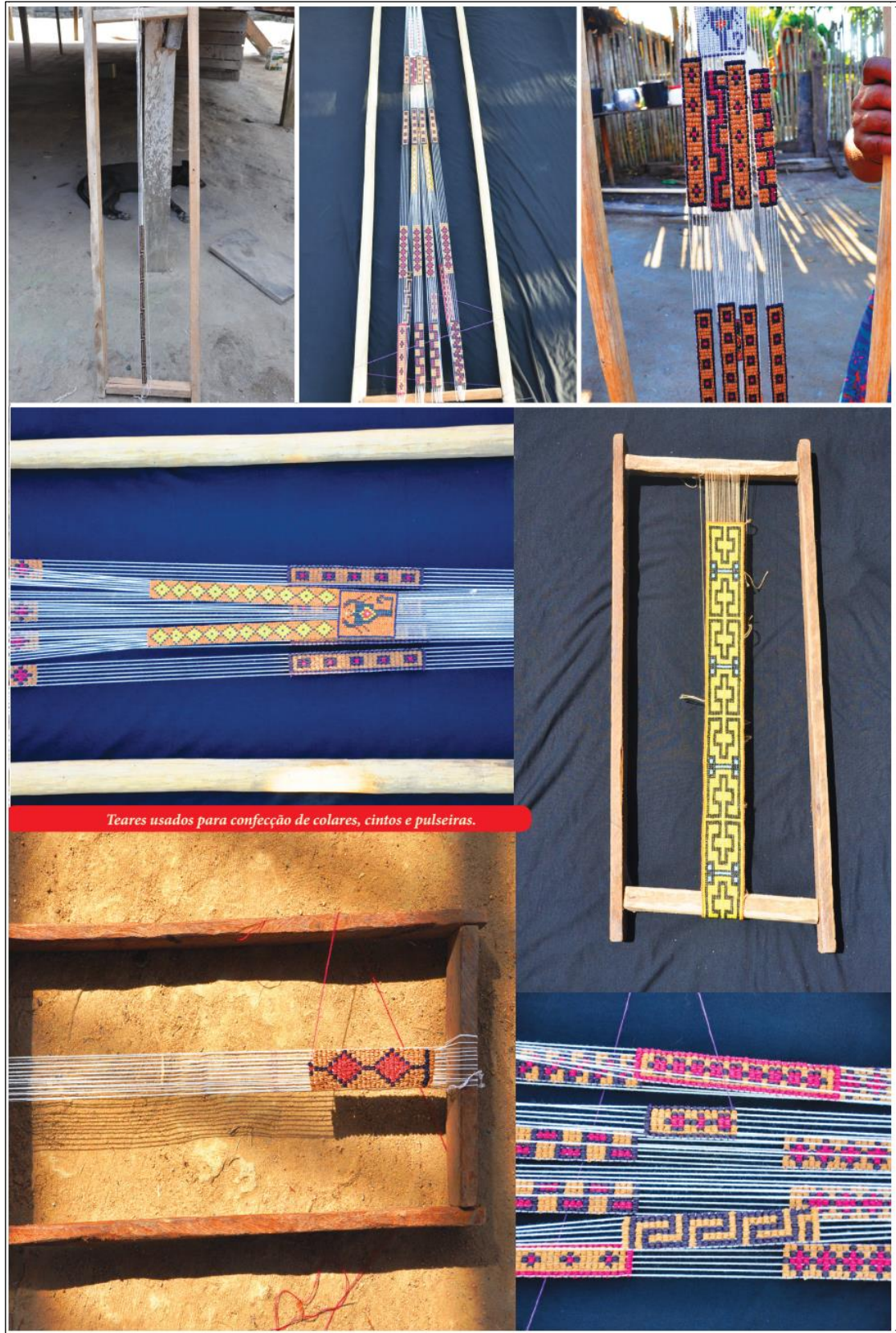
Figura 32 – Tear linear para produção de colares, cintos e pulseiras em miçangas de vidro e semente de morototó.
