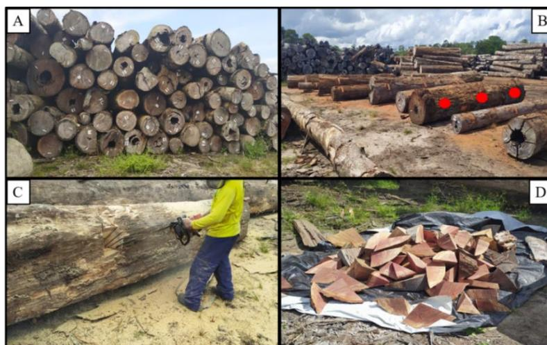
**Figura 2:** Procedimentos de coleta do material lenhoso para análises em laboratório.
