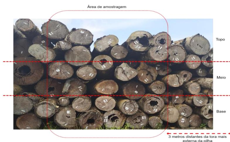
**Figura 1:** Esquema de amostragem utilizado para a escolha das toras utilizadas no estudo.
