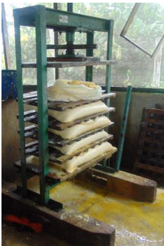
Figura 2: Geração da manipueira após a prensagem da mandioca
