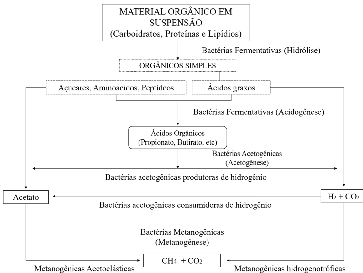
Figura 8: Representação esquemática das sequências metabólicas e grupos envolvidos na digestão anaeróbia
