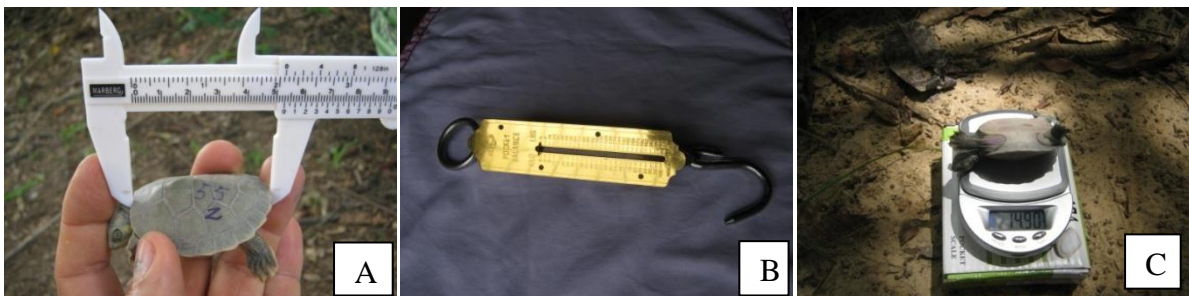
Figura 8: Equipamentos para aferição das medidas dos animais capturados. (A) paquímetro para medição de filhotes (B) Balança para adultos; (C) balança para filhotes com pesagem de um exemplar. Fotos: Josué Carvalho.
