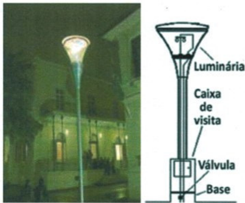
Figura 14 – Iluminação pública com biogás.
