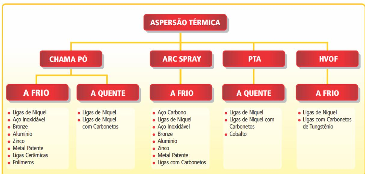
**Figura 26** – Diagrama com materiais e processos da aspersão térmica.
