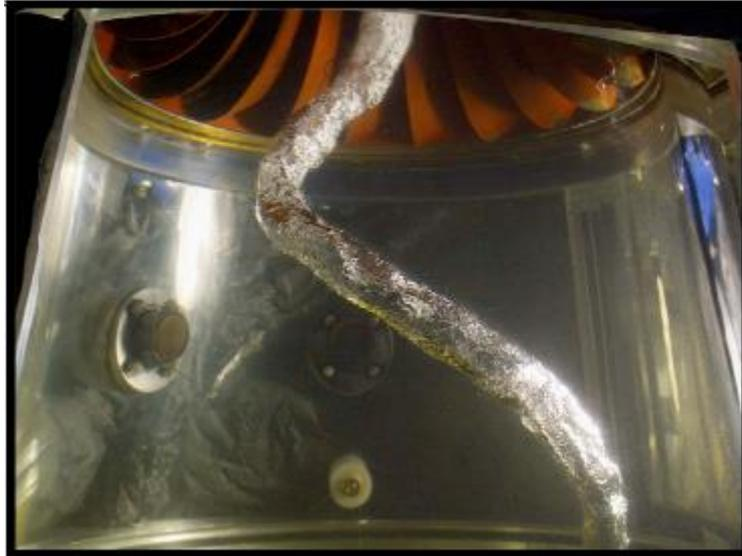
**Figura 12** - Cavitação em vórtice numa turbina Francis.
