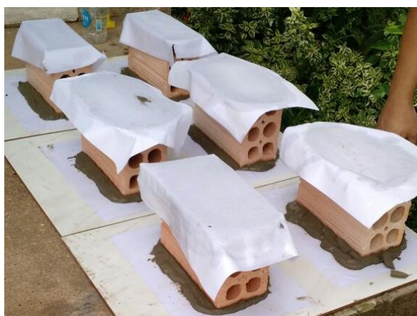
Figura 13 - Capeamento dos blocos cerâmicos.
