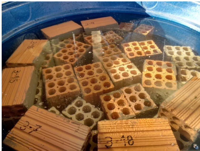
Figura 15 - Blocos cerâmicos imersos em água por um período de 12h.
