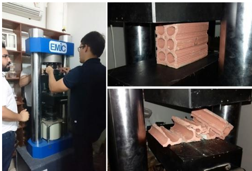
Figura 16 - Montagem da EMIC DL30000N, seguido da ilustração do bloco antes e após o ensaio.
