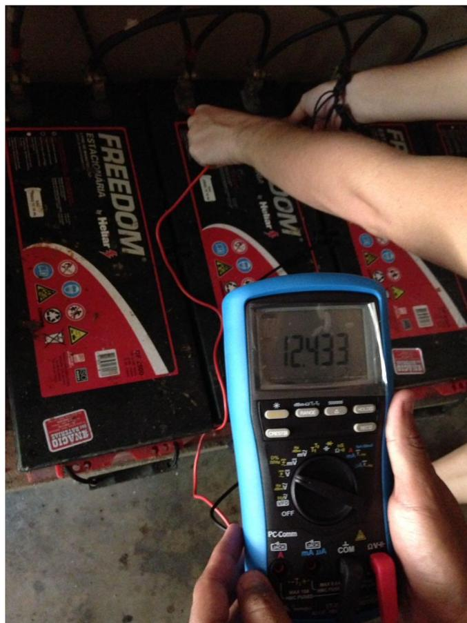
**Figura 9.** Medida de tensão no banco de baterias em funcionamento. Fonte: Autor
