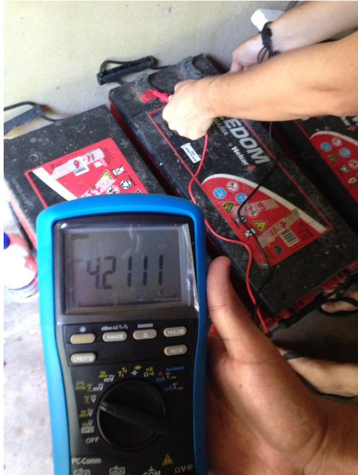
**Figura 10.** Medida de tensão em baterias fora de operação. Fonte: Autor
