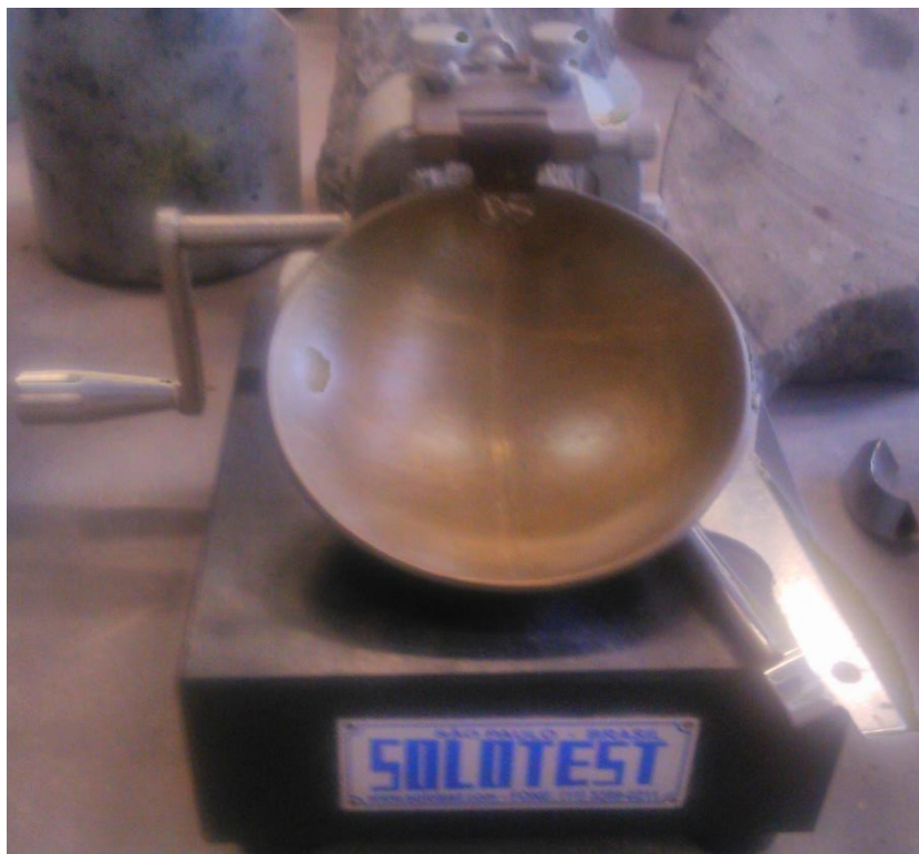
Figura 11: Aparelho de Casagrande para ensaio de limite de liquidez. Laboratório de Solos do IFPA. Fonte: Autores.
